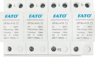
CF3U-A是一个多层次火花间隙器件，该装置由多层次高能石墨电极圆盘与高耐热的特氟纶隔层火花间隙组成，可靠的保证了火花间隙外泄电火产生，因此在安装时不必专门预留外泄电弧空间。
