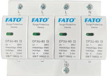
CF3U-80系列电涌保护器适用于交流50/60Hz, 800V及以下的TN-S、TN-C-S、TT、IT等供电系统，作为雷击等电位连接，其设计依据符合GB/T18802.11、IEC61643-1，外壳设计安装在35mm电气导轨上，该产品内置失效脱离装置，当电涌保护器因过流过热、击穿失效时，失效脱离装置能自动的将其从电网上脱离，同时可视告警指示模块变成红色(故障)。
