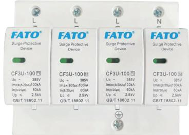
CF3U-100系列电涌保护器适用于交流50/60Hz, 800V及以下的TN-S、TN-C-S、TT、IT等供电系统，作为雷击等电位连接，其设计依据符合GB/T18802.11、IEC61643-1，外壳设计安装在35mm电气导轨上，该产品内置失效脱离装置，当电涌保护器因过流过热、击穿失效时，失效脱离装置能自动的将其从电网上脱离，同时可视告警指示模块变成红色（故障）。
