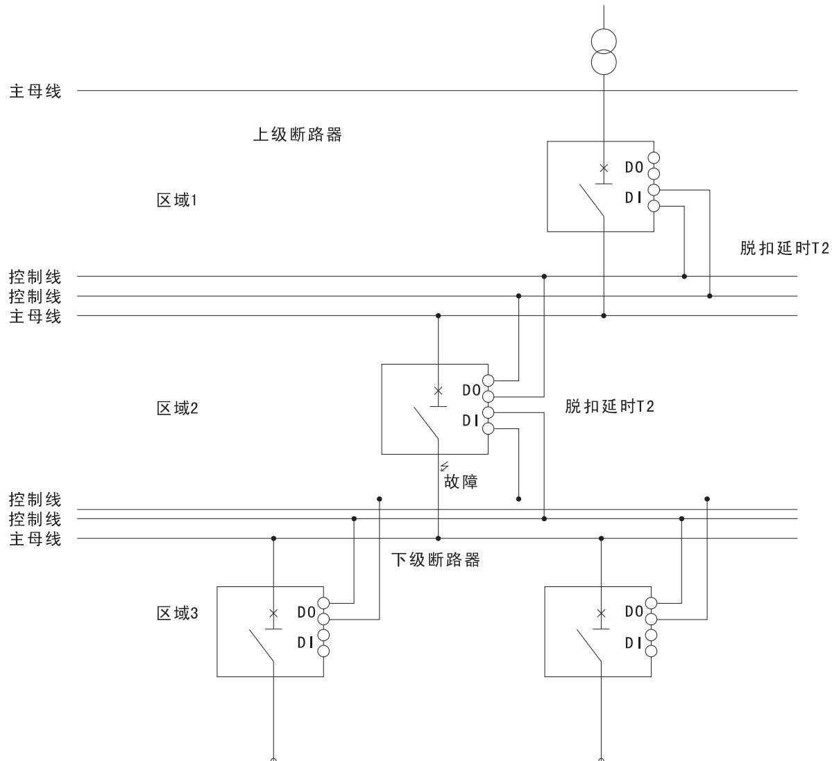
当多台CFW3s断路器上下连接在一起时，选择区域选择性联锁功能可确保断路器上下级完全选择性保护，这样减少了故障动作范围，并缩短了断路器的分断时间，此功能适用于断路器短路短延时和接地故障保护。
