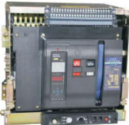
抽屉式断路器由断路器本体和抽屉座组成。抽屉座两侧有导轨，导轨上有活动的导板，断路器本体架落在左右导板上。抽屉式断路器是通过断路器本体上的母线插入抽屉座上的桥式触头来连接主回路的。摇动抽屉座下部横梁摇动手柄，可实现抽屉式断路器的三个工作位置(摇手柄旁有位置指示)，且有三位置锁，更可靠地确定所在位置，防止本体滑落。
