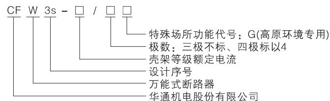
选择特殊场所CFW3s系列智能型万能式断路器可满足光伏、风电、高原和低温至-40℃环境条件下使用,符合GB/T 20645《特殊环境条件 高原用低压电器技术要求》,通过标准规定的相关试验。
