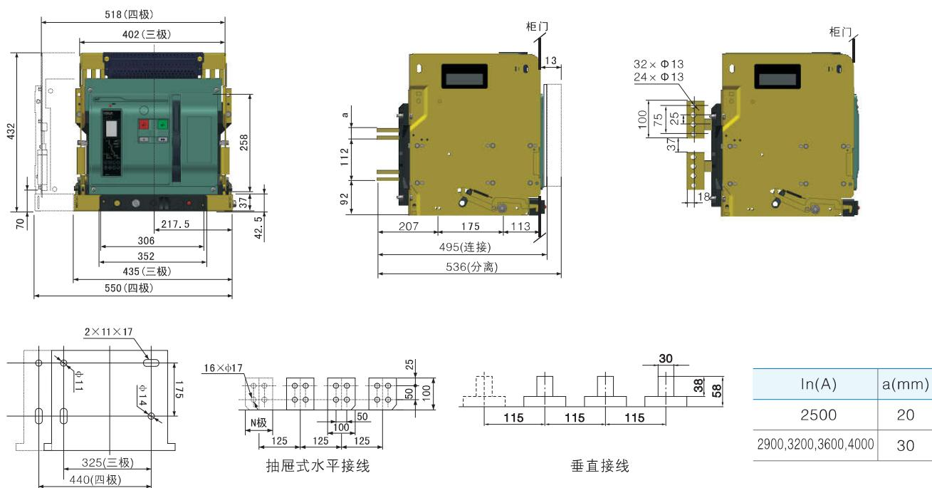
抽屉式断路器安装尺寸及外形尺寸(CFW3s-6300、6300/4P)
