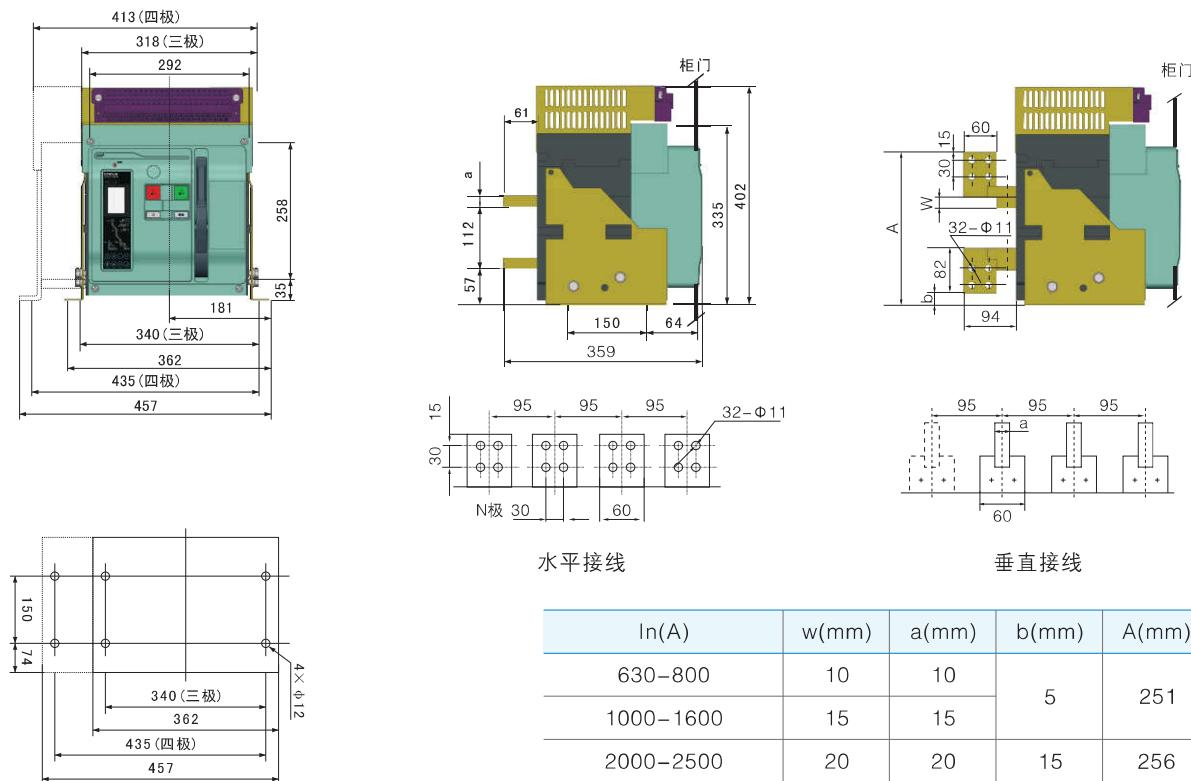
固定式断路器安装尺寸及外形尺寸(CFW3s-4000、4000/4)
