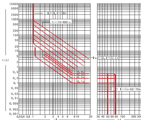
图1 基本功能(长延时短延时及瞬时保护)
