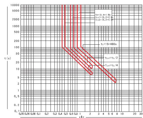
图4 负荷监测及控制(双负荷限制的保护特性)
