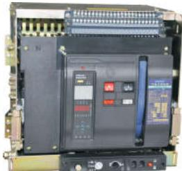
CFW3s系列智能型万能式断路器(以下简称断路器),适用于交流50Hz,额定工作电压AC400V、AC690V,额定电流6300A及以下的配电网络中,用来分配电能,保护线路及电源设备免受过载、欠电压、短路、单相接地等故障的危害;同时也可作为隔离开关使用。该断路器具有智能化保护功能,选择性保护精确,能提高供电可靠性,避免不必要的停电。
