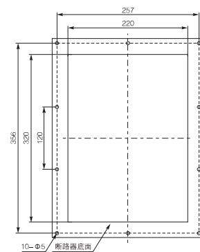
CFW3s-1600 固定式断路器面板开孔尺寸
