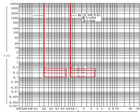
图2 接地故障保护
