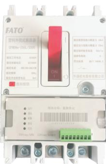
量测开关适用于交流50Hz、额定电流50A至250A、额定工作电压400V的三相四线的电网中。智能量测开关由量测单元模块和断路器组合而成。量测单元模块支持热插拔和互换，可实现配电线路用电量、电压、电流、温度等数据高精度测量，并具备数据存储、處理及HPLC通信等功能。我司这款量测单元模块满足行业标准功能，同时支持低压供电线路拓扑关系识别，计量箱管理，窃电预警、停电事件上报、线损分析研判、故障自动诊断等多项物联感知功能。断路器具有过载长延时、短路短延时、短路瞬时三段保护功能。
