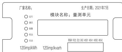
图6 量测单元模块正面示图
