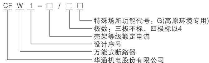
选择特殊场所CFW1系列智能型万能式断路器可满足光伏、风电、高原和低温至-45℃环境条件下使用,符合GB/T 20645《特殊环境条件 高原用低压电器技术要求》,通过标准规定的相关试验。
