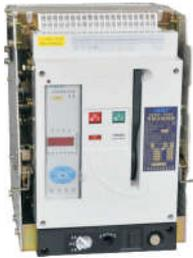
CFW1系列万能式断路器(以下简称断路器),适用于交流50Hz,额定工作电压AC400V、AC690V,额定电流6300A及以下的配电网络中,用来分配电能,保护线路及电源设备免受过载、欠电压、短路、单相接地等故障的危害;同时也可以作为隔离开关使用。该断路器具有智能化保护功能,选择性保护精确,能提高供电可靠性,避免不必要的停电。
