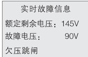
图11 欠压跳闸：当前电压小于档位设定的电压时，显示欠压故障。
