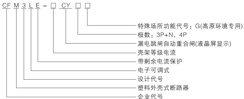
选择特殊场所CFM3LE(CY)自动重合闸剩余电流动作断路器可满足光伏、风电、高原和低温至-20℃环境条件下使用，符合GB/T 20645《特殊环境条件 高原用低压电器技术要求》，通过标准规定的相关试验。
