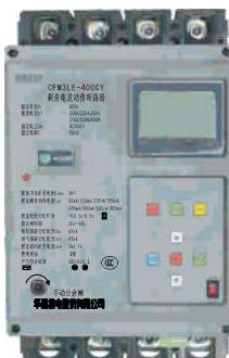
CFM3LE(CY)系列电子式剩余电流断路器的额定绝缘电压为800V，适用于交流50Hz，额定电压400V，额定电流至630A的三相四线中性点直接接地( TT )配电网络。用于提供间接接触保护；防止因设备绝缘损坏，产生接地故障电流而引起的火灾危险；并可用来分配电能和保护线路的过载和短路；对线路的过压、欠压、缺相具有保护功能。
