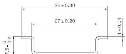
图2 安装轨尺寸
