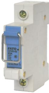
CFH5系列隔离开关(以下简称开关)适用于交流50Hz、额定电压230V(1P、2P)、400V(3P、4P)、额定电流至125A的电路中,主要供无负载情况下接通或断开电路,作为线路与电源接通或隔离之用。尤其适合线路检修时有效隔离电源并防止意外合闸,以确保检修人员的操作安全。符合标准:GB/T 14048.3、IEC60947-3。
