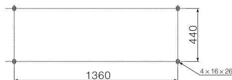
图2 ZW32-40.5型断路器安装孔尺寸
