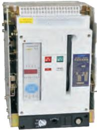
CFW8系列万能式断路器(以下简称断路器),适用于交流50Hz,额定工作电压AC400V、AC690V,额定电流3200A及以下的配电网中,用来分配电能,保护线路及电源设备免受过载、欠电压、短路、单相接地等故障的危害;同时也可以作为隔离开关使用。该断路器具有智能化保护功能,选择性保护精确,能提高供电可靠性,避免不必要的停电。
