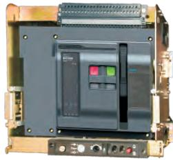
CFW3系列双电源自动转换开关，主要由两台CFW45或CFW1或CFW3万能式断路器、机械联锁及双电源转换控制器等组成。适用于50Hz额定工作电压400V的两路三相四线制电网中。对供电的两路电源的三相电压同时检测，当任意一相发生过压、欠压(包括缺相)，即自动从异常电源切换到正常电源；用于电网发电系统的产品还能发出发电和卸载信号，是一种性能完善、安全可靠、自动化程度高、使用范围广的双电源自动切换产品。
